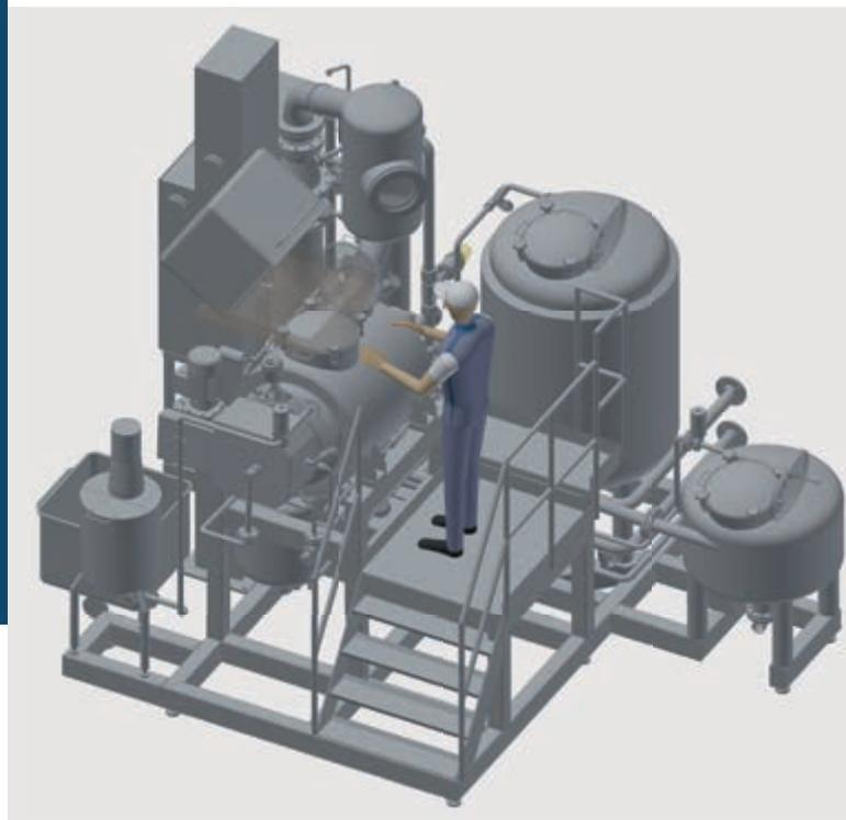
No módulo de cocção JamMod250, a cocção de frutos com mistura de açúcar, pectina e outros aditivos, com espessamento subsequente sob vácuo ocorre num único recipiente de processo. O sistema foi concebido para perdas de produto mínimas, tempos de cocção e limpeza reduzidos, conservação da textura e das cores e aromas naturais dos frutos.
