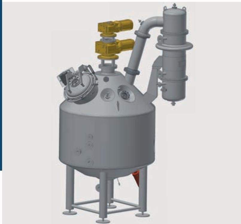
I bollitori /raffreddatori verticali dispongono di tutti i collegamenti e le aperture di caricamento necessari nel rispetto dei requisiti dei prodotti, di una lavorazione asettica e degli standard dei clienti.
