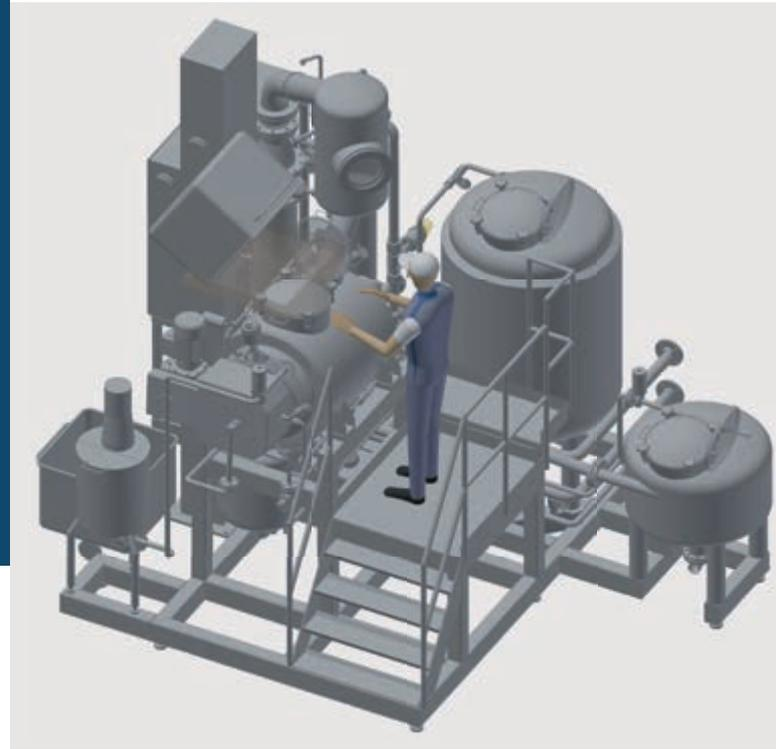
En el módulo de cocción JamMod250, la cocción de las frutas mezcladas con azúcar, pectina y otros aditivos y el espesamiento posterior al vacío se realizan en el mismo contenedor de proceso. La instalación está concebida para mínimas pérdidas de producto, tiempos cortos de cocción y limpieza, para la conservación del troceado del producto y también de los colores y aromas naturales de la materia prima.
